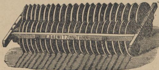
In allen Grössen und Breiten und in verschiedenen Scherern. Die doppelten Ringelwalzen mit Eisenrahmen lassen sich auch als einfache Ringelwalzen benutzen. Beide sind mit Deichseln versehen. Auf Verlangen werden sämtliche Walzen auch mit Transportvorrichtung versehen.
