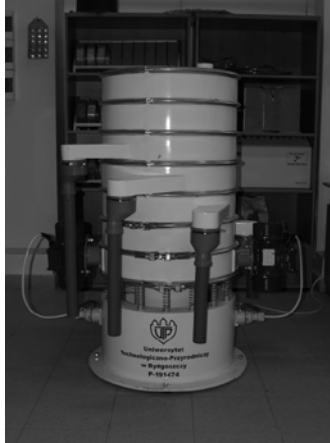
Rys. 2. Przesiewacz zataczająco-śrubowy Fig. 2. The rolling-screw screen
