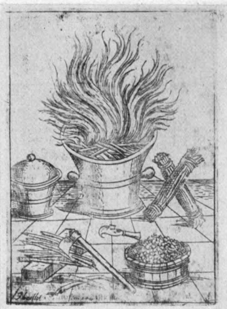
Abb. 19. Die Holzkohle für die Schießpulverherstellung wurde lange Zeit in Kesseln durch Verkohlen von Holz gewonnen. (Das Bild stammt aus einem französischen technologischen Werk von Boillot, 1598)
