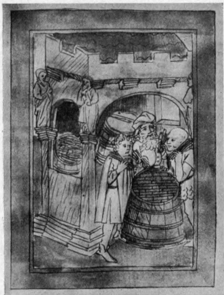
Abb. 20. Hier wird die Kohle für das Schießpulver in einem mit Ziegelsteinen ausgekleideten Faß gewonnen. (Aus einer in Wien befindlichen Bilderhandschrift, um 1400)
