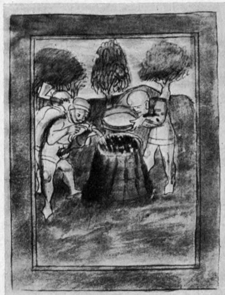
Abb. 21. Nach dem Aufheben des Deckels des Verkohlungsgefäßes wird die heiße Holzkohle mit einer Flüssigkeit aus einem Krug abgelöscht. (Das Bild stammt aus derselben Bilderhandschrift wie das Bild oben)
