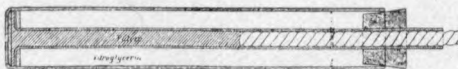
Abb. 37. Nobels Zünder: eine zur Detonation gebrachte kleine Ladung Schießpulver bringt das umgebende Nitroglycerin zur Explosion (Initialzündung!). (Aus „Initialexplosivstoffe“ von Dr. Richard Escales und Dr. Alfred Stettbacher. Leipzig 1917, Veit & Co.)
