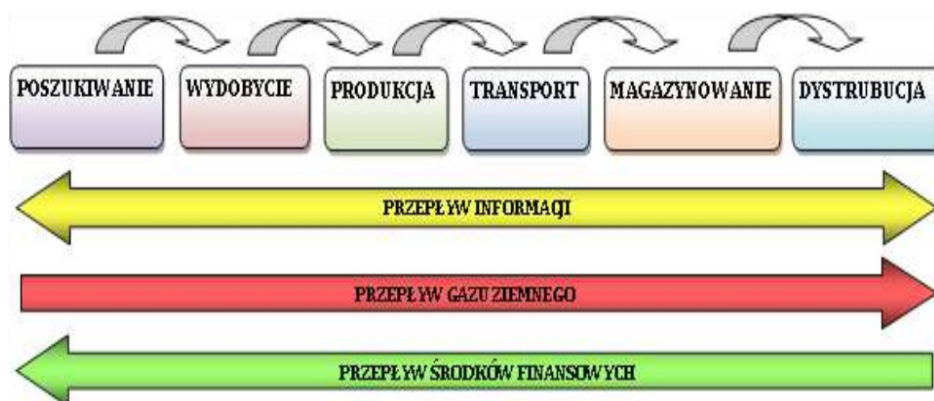
Rysunek 2. Łańcuch logistyczny dostaw gazu ziemnego
