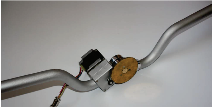
Rys. 4. Prototyp egzoszkieletu kończyny górnej Fig. 4. Prototype of upper limb exoskeleton
