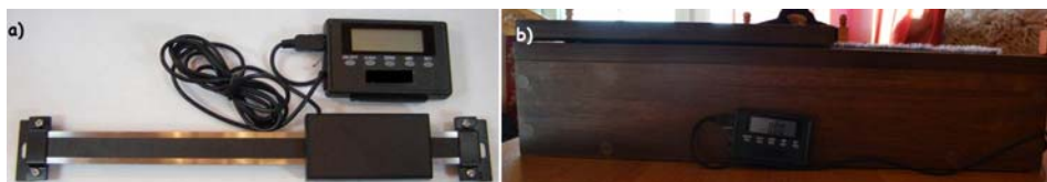
Rys. 2. Liniał pomiarowy: a) widok liniału pomiarowego z wyświetlaczem, b) wyświetlacz liniału pomiarowego po montażu do urządzenia pomiarowego Fig. 2. Electronic caliper: a) electronic caliper with display, b) display of electronic caliper installed on the device
