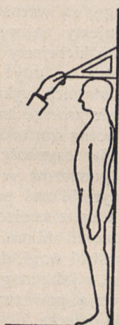
Rys. 8. Pomiar wysokości z pomocą podziałki na ścianie i trójkąta rysunkowego.
