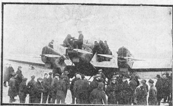
Dnia 24 lutego odleciał do Angory w Turcji Azjatyckiej samolot typu Junkersa zbudowany w fabryce A. B. Słygyndustry w Linhann z metalu i posiadający trzy silniki o sile 900 koni a skrzydła o rozpiętości 28 i pół metra. Waga samolotu wynosi 3600 kg a z ładunkiem i pasażerami 6000 kg. Zdjęcie nasze przedstawia samolot na lotnisku Mokotowskim przed odlotem.
