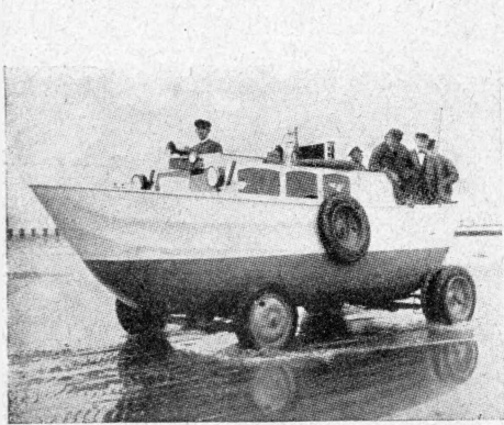
Samochód lądowo-wodny, zbudowany przez firmę samochodową w Cuxhaven. służyć on będzie do ścigania przemytników na lądzie i morzu.
