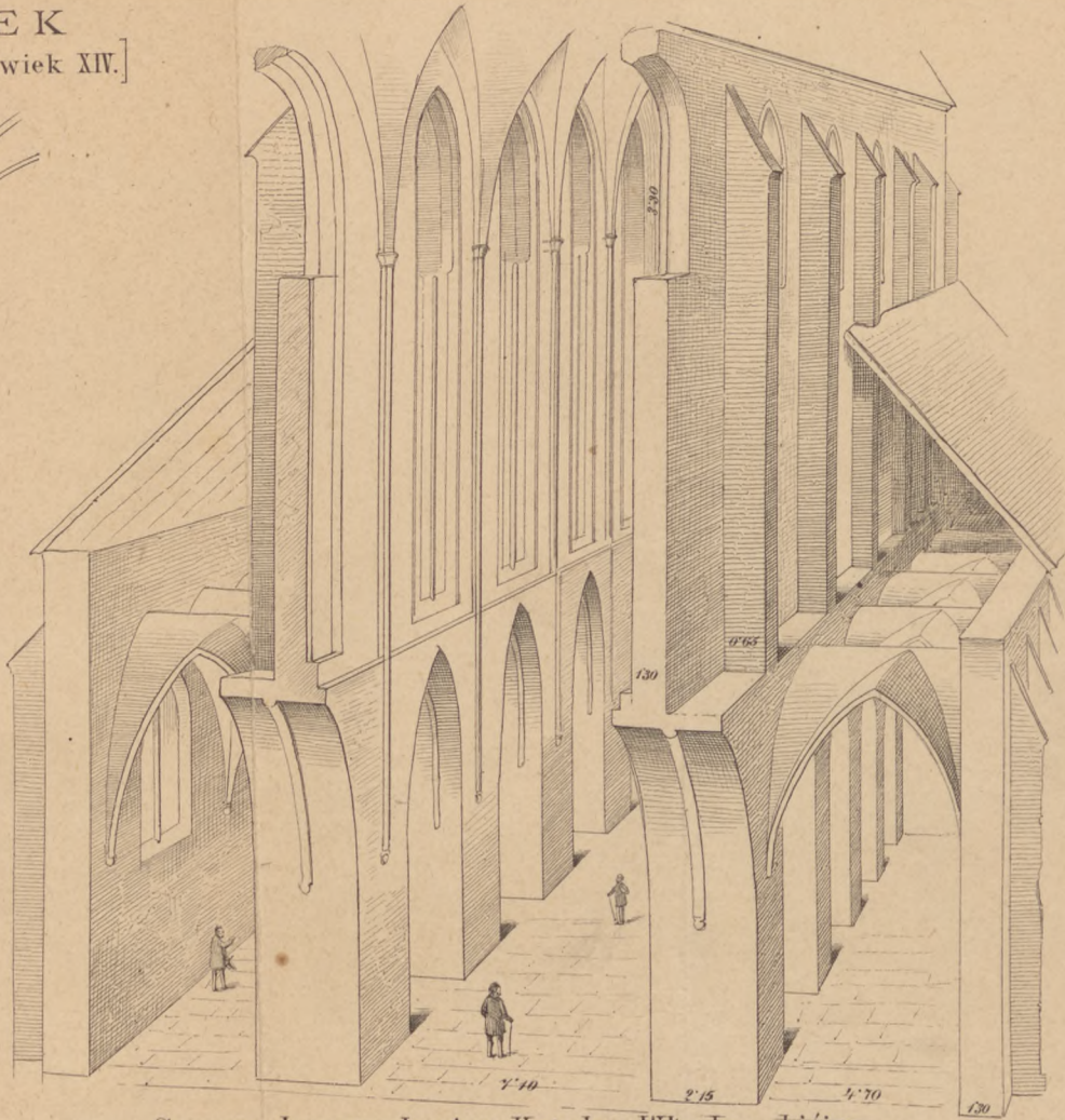
System konstrukcyjny Katedry Włocławskiej. Rohbau.
