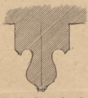
Profil żeber ceglanych sklepienia.
