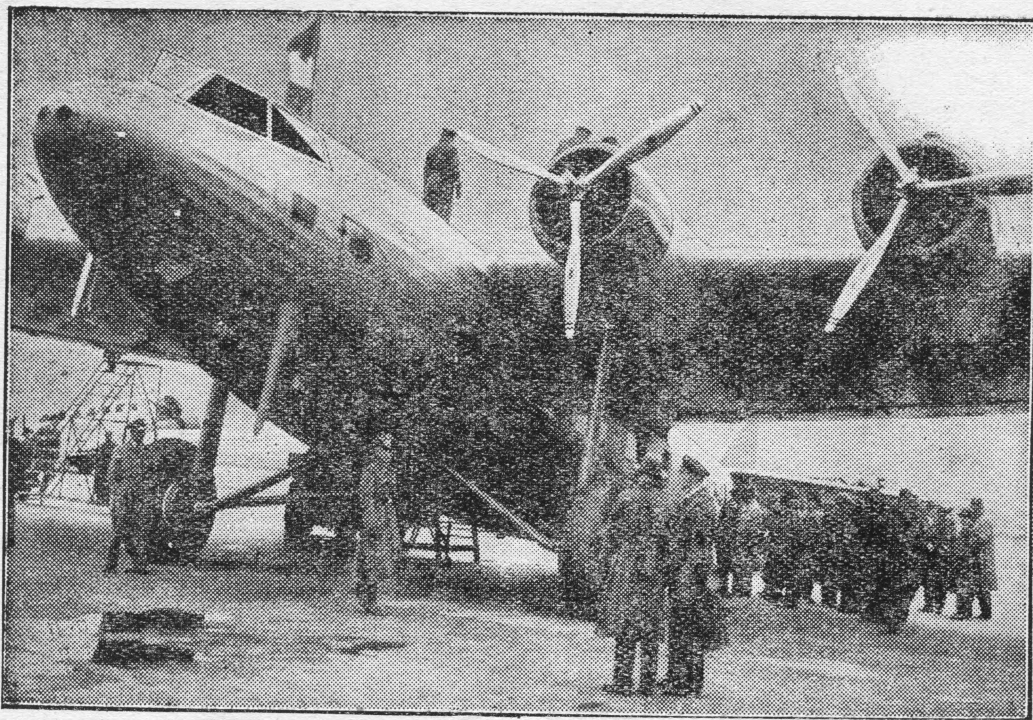
Na linii Amsterdam— Berlin zaczął kursować wielki samolot niemiecki. Posiada on 4 motory o sile 700 KM. każdego, wobec czego rozwija szybkość do 300 km. na godzinę. Samolot zabiera 5 ludzi załogi, 32 pasażerów oraz 122 centnary towarów.
