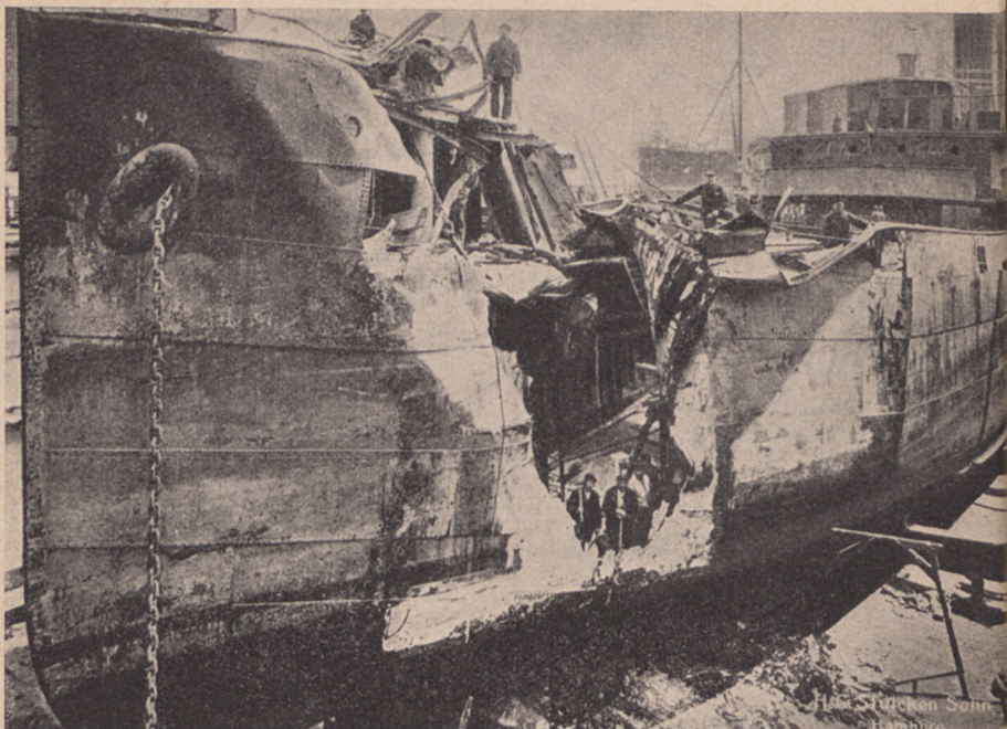
W doku. Statek z uszkodzoną przy zderzeniu burtą.
