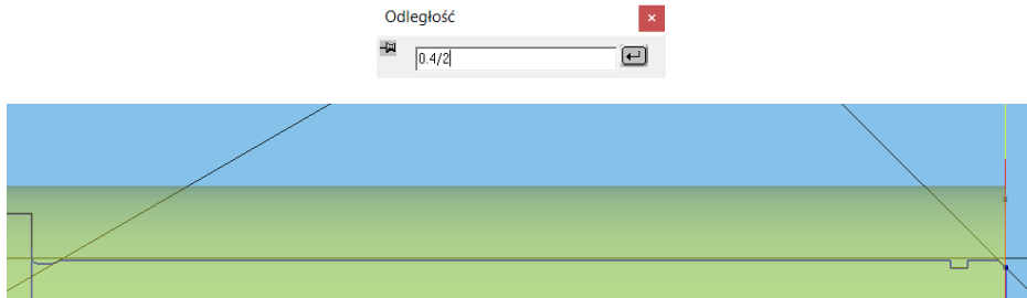
Rys. 6.4. Okno do wpisywania wartości odległości odsunięcia (na górze) i trzy proste utworzone na podstawie polecenia Linia 1 (niżej)
