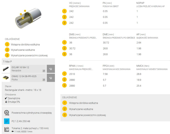
Rys. 4.7. Parametry skrawania zaproponowane na podstawie programu CoroPlus ToolGuide firmy Sandvik Coromant [21]
