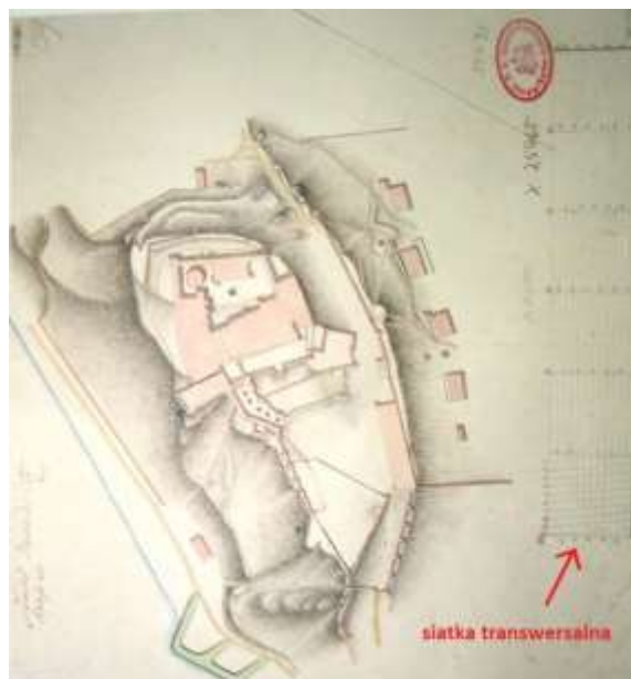
Ryc. 4. Plan inwentaryzacyjny zamku z siatką transversalną z ok. 1750 r., odnaleziony przez W. Sieradzana w latach 90. XX w.
