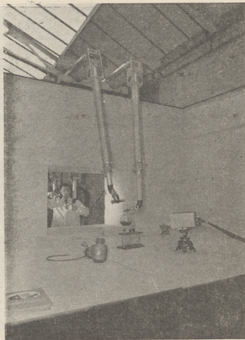
BADANIA ATOMOWE: „Mechaniczne ręce” pomagające w przeprowadzaniu badań materiałów radioaktywnych. Laborant operuje „rękami” ukryte za ochronną ścianą
