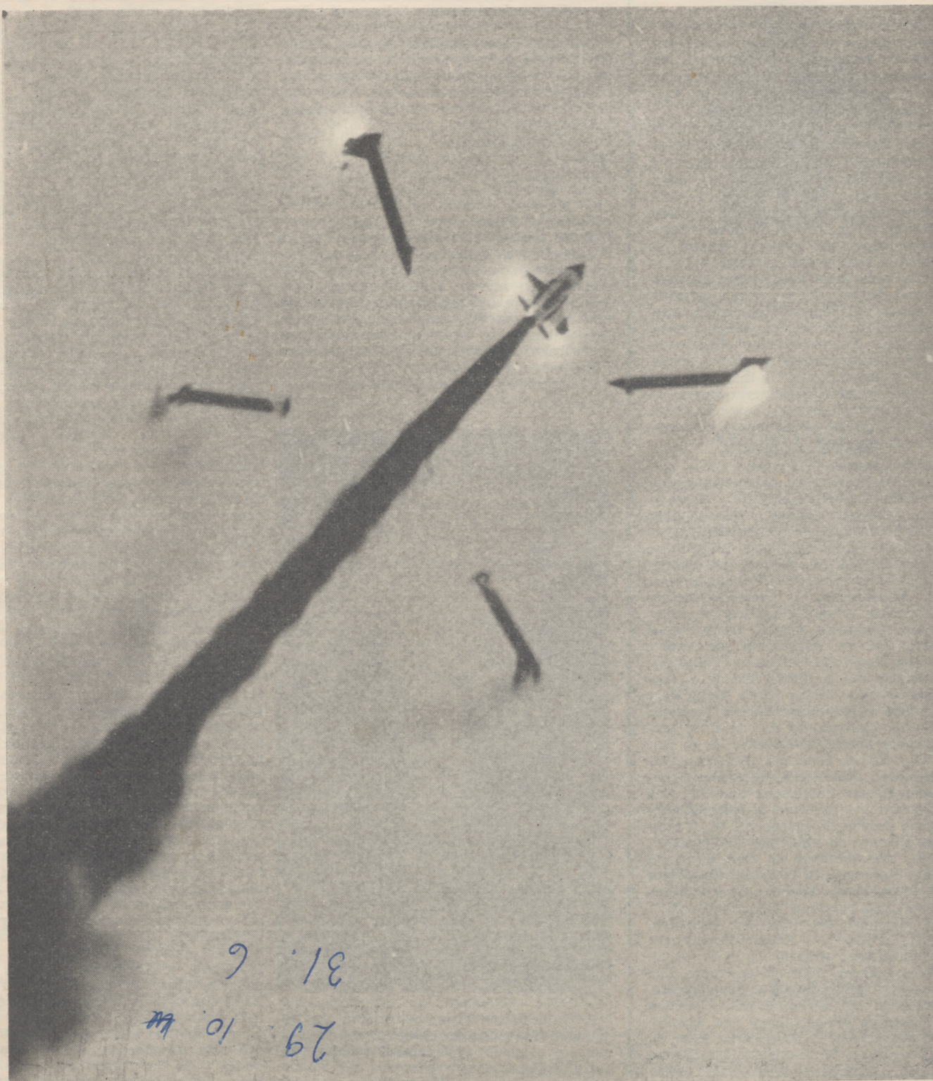
Dramatyczny moment odrzucenia bocznych silników. Rakieta przeciwlotnicza English Electric „Thunderbird” leci teraz ze szczytową prędkością do napowietrznego celu. (Patrz artykuł na stronie 9).
