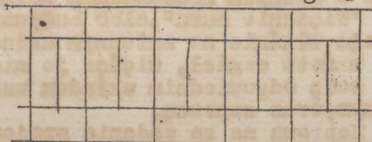
II warstwa muru gr. 2-u cegieł
