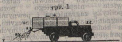
SC—SAMOCHOD, C—CYSTERNA Z GAZEM BOJOWYM, RR—RURA ROZPRYSKIWACZA, RV—ROZPRYSKIWACZ GAZU BOJOWEGO, T—TEREN
