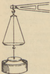
Ryc. 201. Woda, przylegająca do szkła, nie traci spójności z wodą w miseczce.
