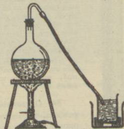
Ryc. 101. Sposób wyznaczenia ciepła parowania wody.
