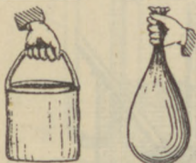
Ryc. 123. Ciśnienie cieczy na ściany boczne wiadra płóciennego i worka gumowego.
