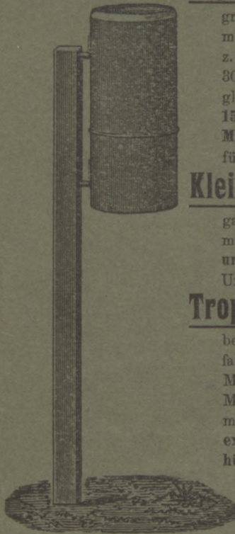
Hellmann's Regen- und Schneemesser, M. 1886, an einem Pfahl in 1 m Höhe.
