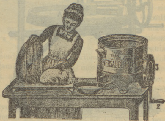
(rys. 82) Odśrodkowcowy eksykator do masła Listera.
