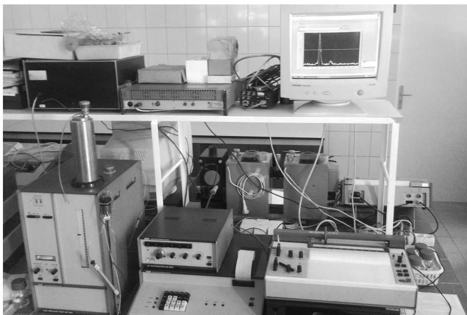
Fot. 4. Stanowisko pomiarów studenckich wyposażone w chromatograf cieczerw Źródło: opracowanie własne.
