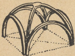
Obr. 42. — Sklepienie krzyżowe. Łuki przekątne są tu kołami.
