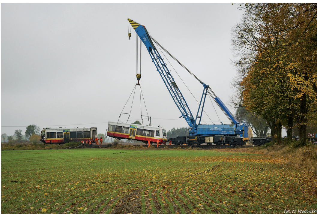
Ryc. 186. Autobus szynowy SA109-009 ustawiany na tory przez specjalistyczny żuraw kolejowy, po wypadku na przejeździe kolejowo-drogowym w Nowym Gronowie 23 października 2017 roku.
