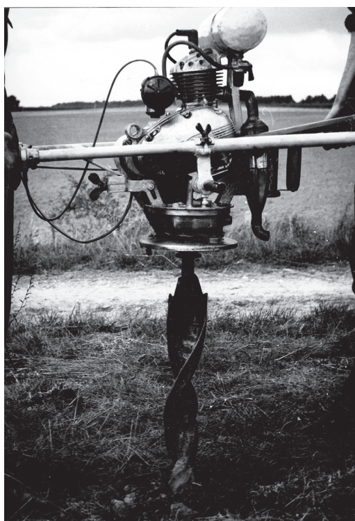
Ryc. 99. Wiertarka uniwersalna z silnikiem spalinowym projektu Ignacego Werry. Źródło: J. Czyż, Kronika Klubu Techniki ...
