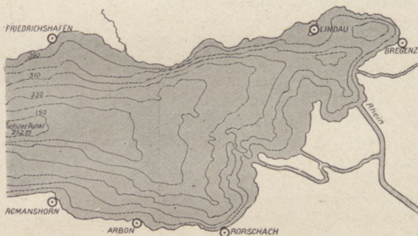
Fig. 55. Tiefenkurven (Teil des Bodensees).
