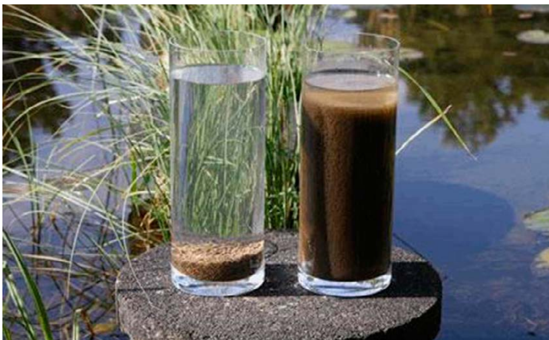
Rysunek 5-2. Porównanie zdolności sedymentacyjnych osadu granulowanego i klasycznego osadu czynnego po 5 minutach sedymentacji [Olivier i in. 2016]
