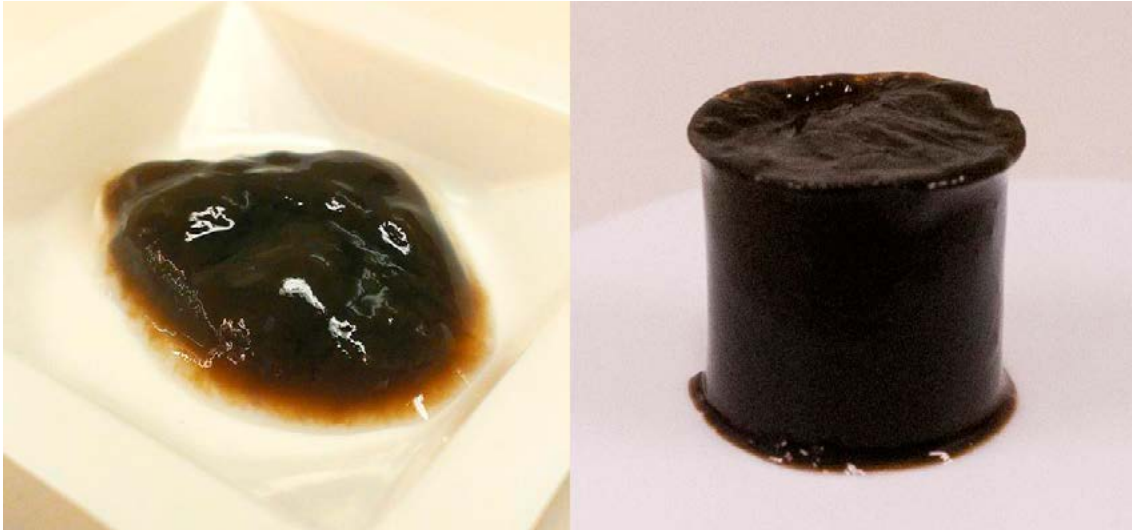
Rysunek 8-4. Wyekstrahowany biopolimer z granulowanego osadu czynnego – Kaumera Nereda Gum [Lavender i in. 2021]
