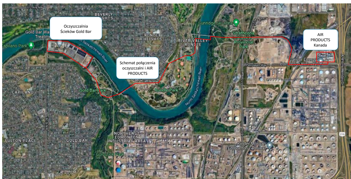
Rysunek 9-9. Ponowne wykorzystanie wody ze ścieków – przykład symbiozy sektora komunalnego i przemysłowego w Edmonton (Kanada) (opracowanie własne na podstawie [mapy Google])
