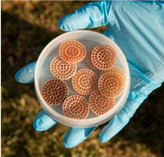
Rysunek 7-9. Podłoże do rozwoju mikroorganizmów Anammox w technologii ANITAMOX [ensia.com]
