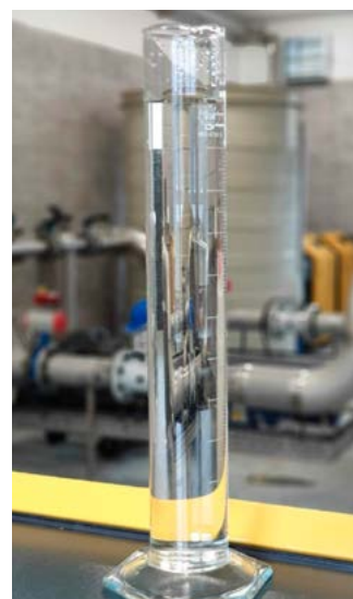
Rysunek 6-6. Wygląd ścieku oczyszczonego w czyszczalni MBR w Muszynie [schwander.pl]
