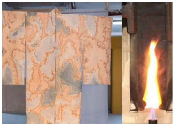
Rysunek 8-6. Test palności materiału z dodatkiem biopolimeru Kaumera Nereda Gum [Bahgat 2021]
