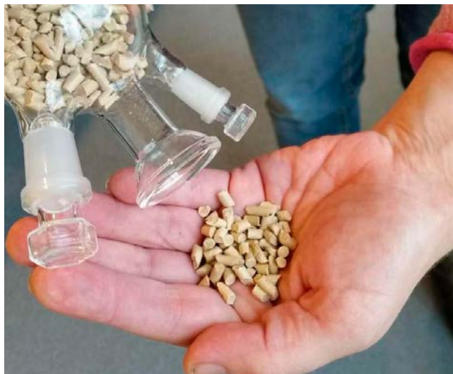
Rysunek 8-2. Wyekstrahowane z osadów ściekowych substancje PHA [Bengtsson i in. 2017]
