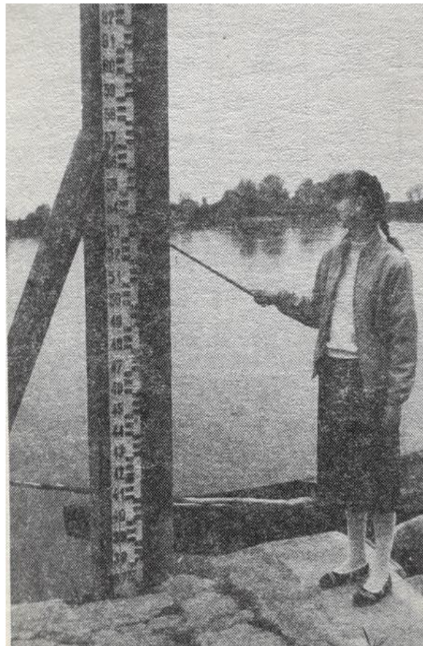
Dawny posterunek obserwacji stanów wody na Wiśle w Grudziądzu z latą wodowskazową (11 V 1988 r.). Fot. K. Hromiak.
