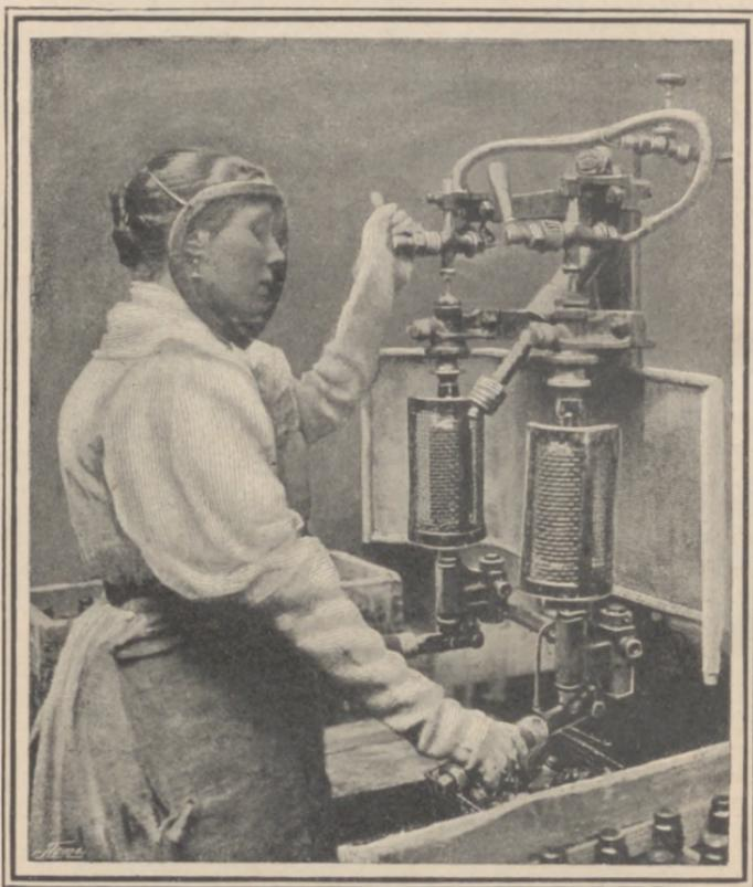
Arbeiterin beim Füllen der Flaschen in einer Mineralwasserfabrik.
