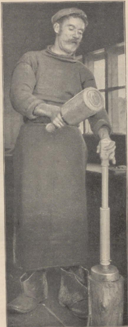
Arbeiter beim Füllen von Raketen in einem Feuerwerkslaboratorium.
