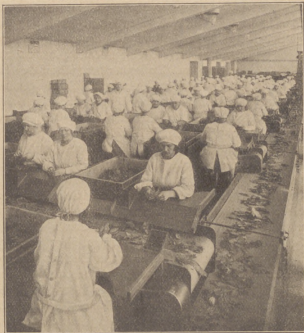
Das „Sammeltransportband“, auf dem sich die ausgesuchten Tabakblätter in genauer Reihenfolge anhäufen.
