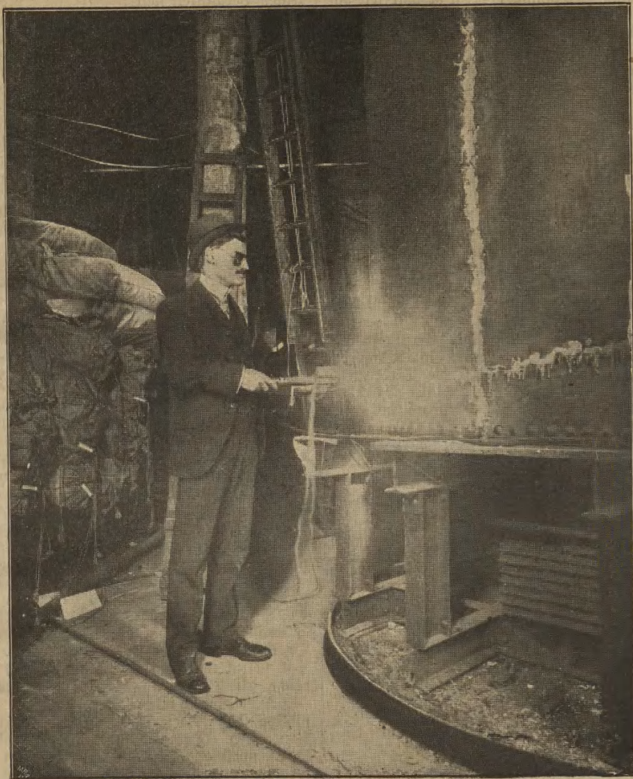
Der amerikanische Erfinder Haschke führt die Durchbrennung einer 25zölligen Stahlplatte mittelst glühender Kohlenspitze vor.
