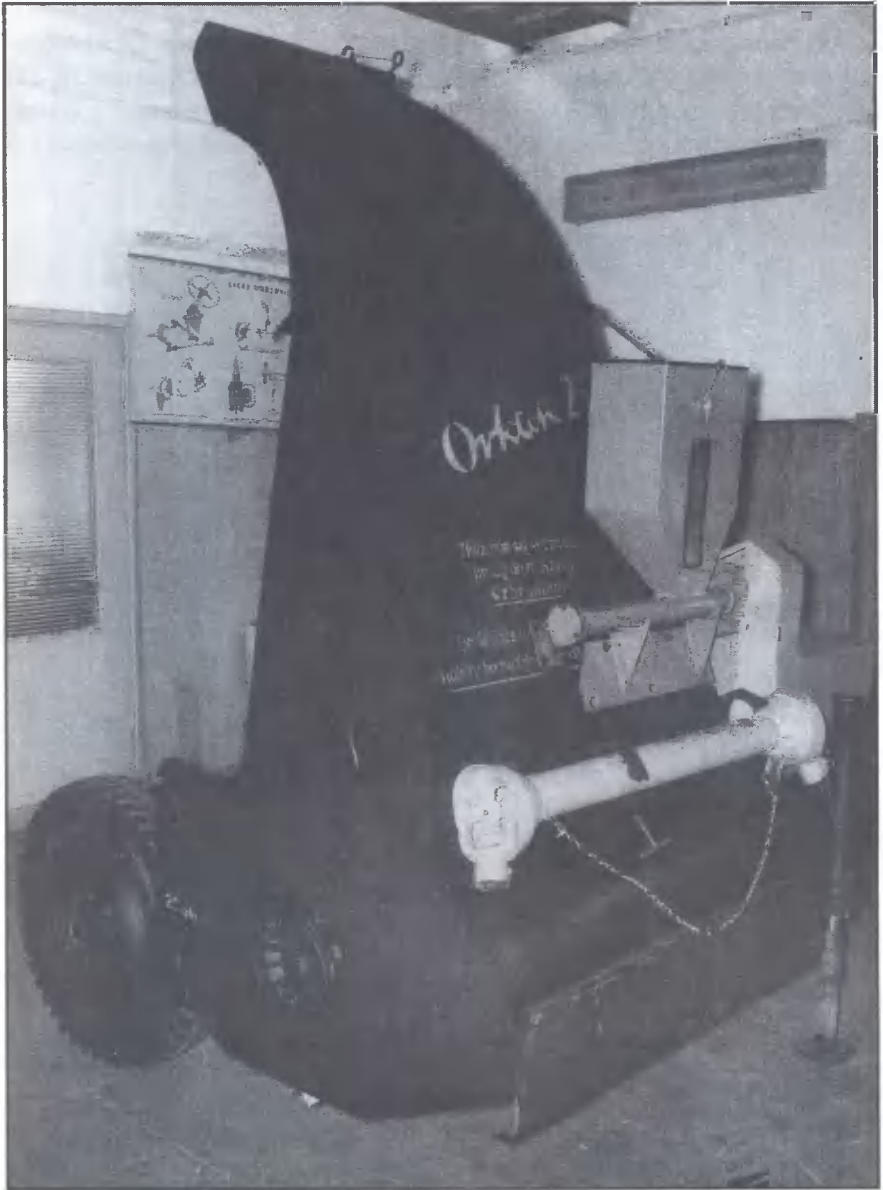
Rys.3. Ślimakowe urządzenie dozujące konserwanty stałe Fig.3. Screw-type device for metering of solid preservatives
