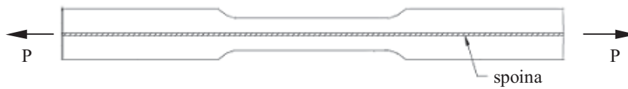
Rys. 2.17. Próbką do badań własności materiałowych spoiny laserowej [1]
