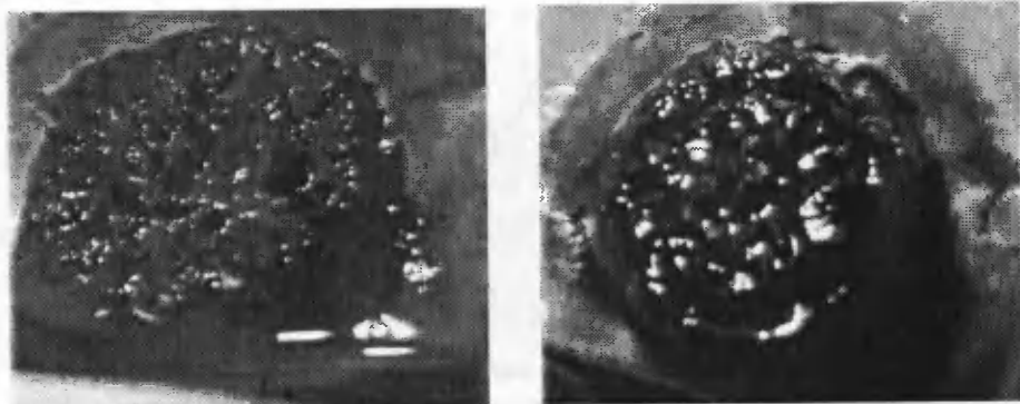
Rys. 5. Zdjęcie tworzących się "jeży" na powierzchni cieczy pod wpływem przyłożonego magnesu
