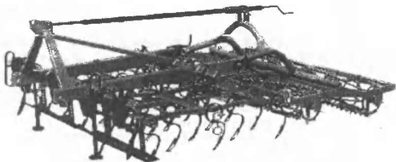
Rys. 4. Agregat uprawowy bierny z wymiennymi zębami brony sprężynowej
