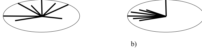
Rys. 3.4. Wady podejścia minimalnej opisanej elipsy przy wyznaczaniu miary nieproporcjonalności obciążenia według wzoru (3.20)
