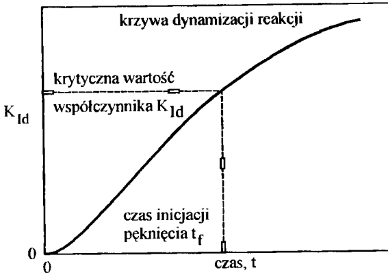
Rys. 1. Wyznaczanie dynamicznej odporności na pęknięcie K_{Id} metodą krzywej dynamicznej reakcji
