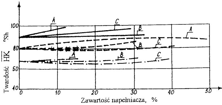
Rys.4. Wpływ zawartości napełniaczy proszkowych na twardość HK
