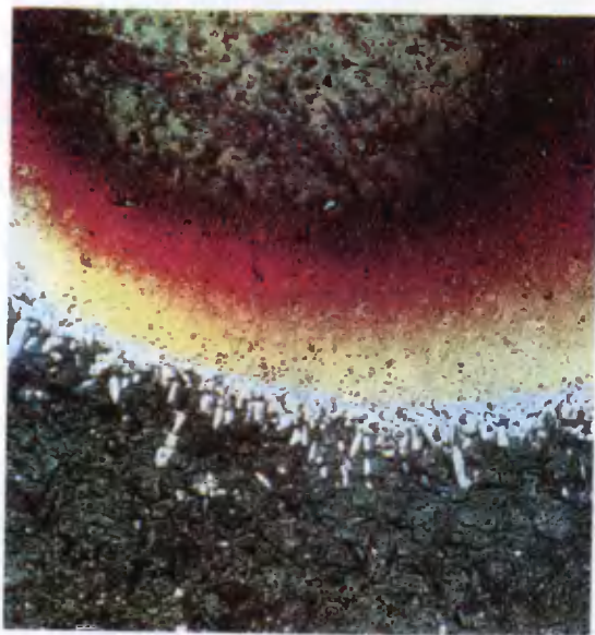
Rys.1. Strefa dyfuzyjna między Cu-drutem (na górze) i Sn-lutem, odczynnik 2, pow. 100 x
