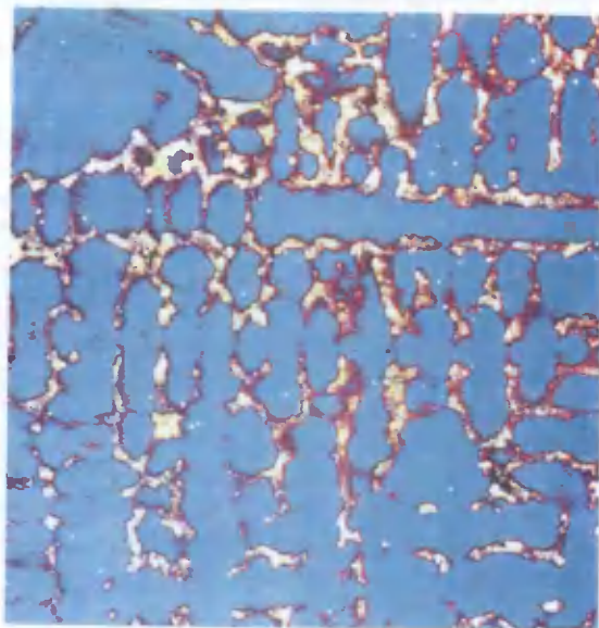
Rys.2. Superstop Ni-Cr20-Mo5-Ti3-Al1 w stanie lanym (dendryty niebieskie, strefy międzydendrytyczne żółte), odczynnik 4, pow. 50x
