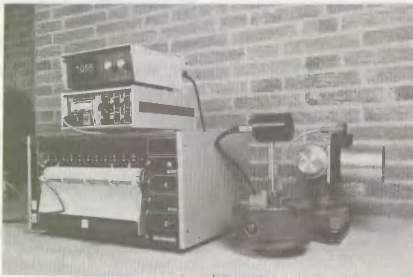
Rys.13. Zestaw aparatury odbierającej promieniowanie laserowe: a) detektor SC-10 UDT, b) wzmacniacz UDT, c) radiometr EG&G, d) rejestrator analogowy, e) fotodioda radiometru EG&G
