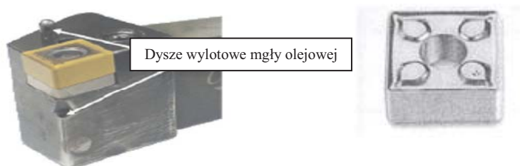
Rys. 6.1. Oprawka nożowa do toczenia wzdłużnego MSS 2525–12-EB z płytką SNMG 120408TA
