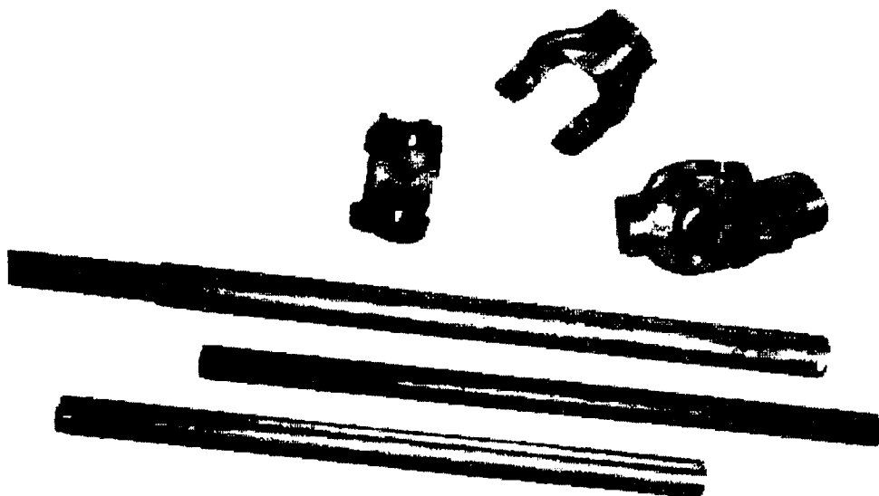
Rys.2. Części wału napędowego: 1) odlewy widłaków z żeliwa sferoidalnego, 2) rury stalowe
