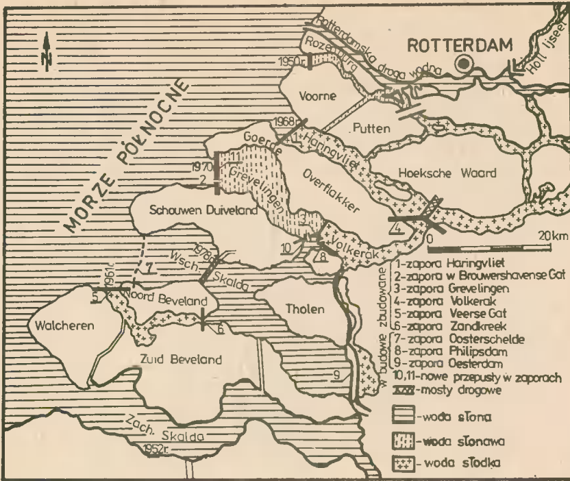
Rys.12. Schemat przetamowań w Planie Delta z uwzględnieniem zmian na Wschodniej Skaldzie wg Klugiewiczza
