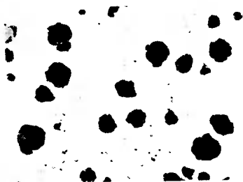
Rys.1. Struktura w stanie surowym. Zgład nietaw. Pow. 100 x
