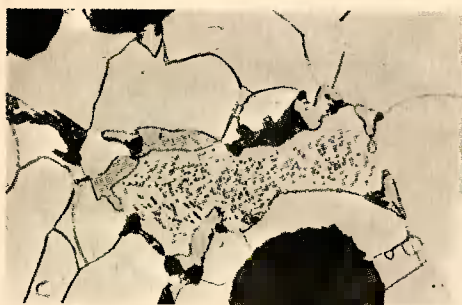
Rys. 40. Struktura żeliwa po obróbce: nagrzanie do 775°C, wygrzanie 2 h, chłodzenie powolne w powietrzu. Widoczny jest obszar ferrytu z cementytem kulkowym, z wyspami nowego perlitu (obszary ciemne) i martenzytu (obszary szare) na jego peryferiach. Pow. 1000 x
