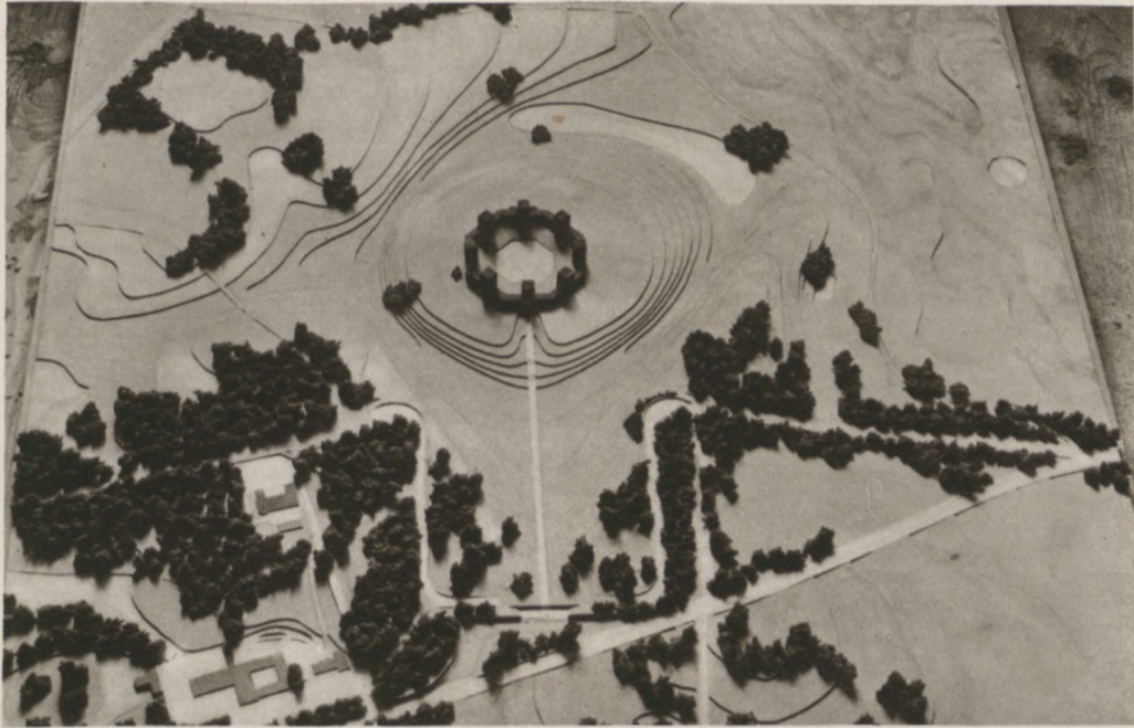
Abb. 4. Schichtmodell für die Landschaftsgestaltung. Die alte Landstraße Hohenstein—Osterode ist vor dem Denkmal unterbrochen und durch eine neue Straße weiter nördlich ersetzt. Durch ein tiefes Ringtal wird der Denkmalsbühl geschaffen. Auf seiner Südseite bildet sich im Tal ein kleiner See
