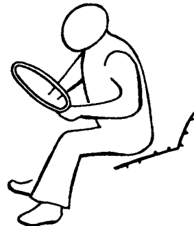
Rys.3. Manewry w zasięgu ręki kierowcy /pozycja 1/. Prawa kończyna górna manewruje przy pulpicie. Prawa kończyna dolna - za pulpitem kierowniczym
